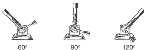
Extrayendo simplemente el mechero de su zócalo de soporte e incorporándolo de nuevo en la posición deseada, puede ajustar la inclinación del mechero, adaptándola a su requerimiento individual. El mechero es así igual de práctico para zurdos y diestros.
