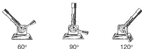
Durch einfaches Herausheben des Brenners aus dem Sockel und erneutes Einsetzen in die gewünschte Position können Sie die Neigung des Brenners auf Ihre individuellen Bedürfnisse einstellen. Der Brenner ist somit für Links- und Rechtshänder gleichermaßen gut geeignet.
