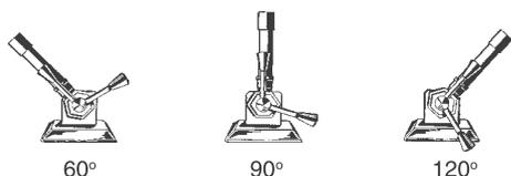
A inclinação do queimador pode ser ajustada às suas necessidades individuais retirando simplesmente o queimador da base e voltando a encaixá-lo com a inclinação desejada. Assim, o queimador é perfeitamente adequado tanto a canhotos como a destros.
