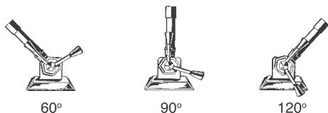
Poprzez proste wyjęcie palnika z podstawki i ponowne osadzenie go w żądanej pozycji można dostosować nachylenie palnika do indywidualnych potrzeb. Palnik jest więc przydatny zarówno dla osób posługujących się prawą jak i lewą ręką.
