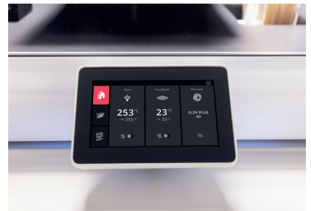
Abb. 1 und 2 Der Filamentdrucker Simplex 2 SX von Renfert überzeugt mit kompakter Bauweise und geschlossenem Bauraum. Das große TFT-Touchdisplay sorgt dafür, dass man alle Funktionen klar strukturiert stets im Überblick hat.
