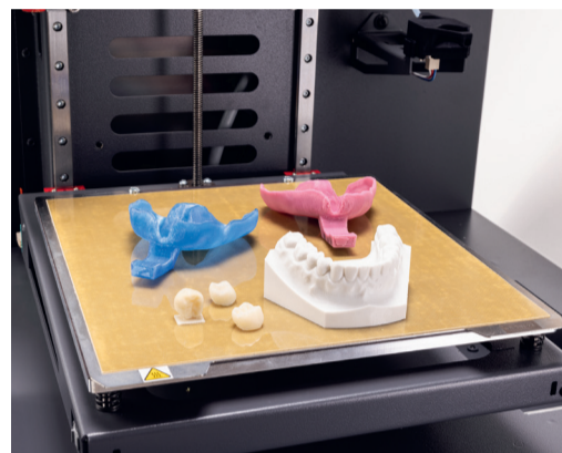
Abb. 3 Das beschichtete Druckbett des Simplex 2 SX Filamentdruckers mit Beispielen der damit gefertigten Dentalstrukturen wie individuelle Abformlöffel, Provisorien und Modelle.
