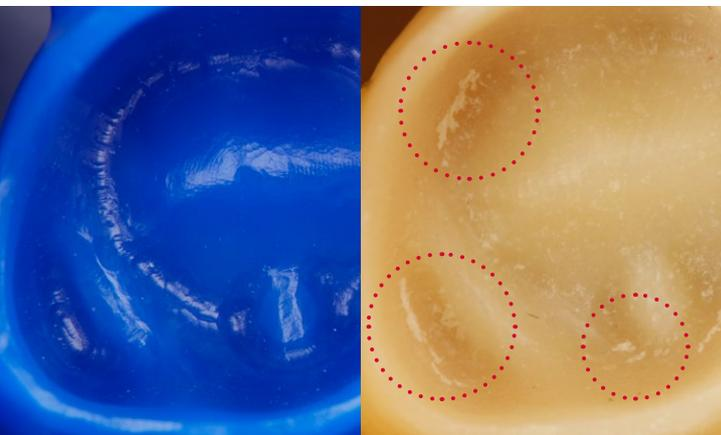
Результат фрезерной обработки: Образование стружки при обработке Renfert EASYblank wax
