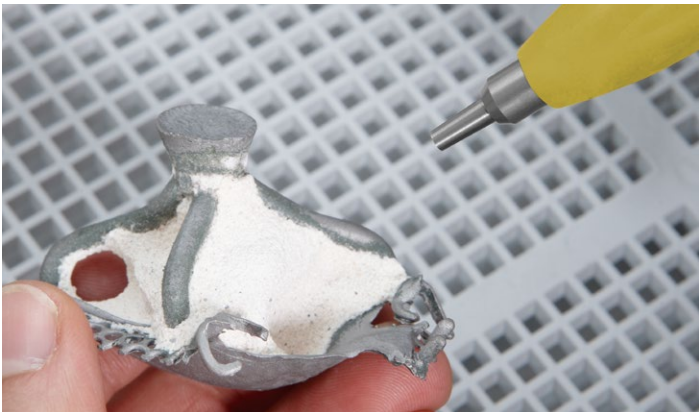
高抗性碳化硼制成的喷嘴, 使用寿命是传统喷嘴的四倍
