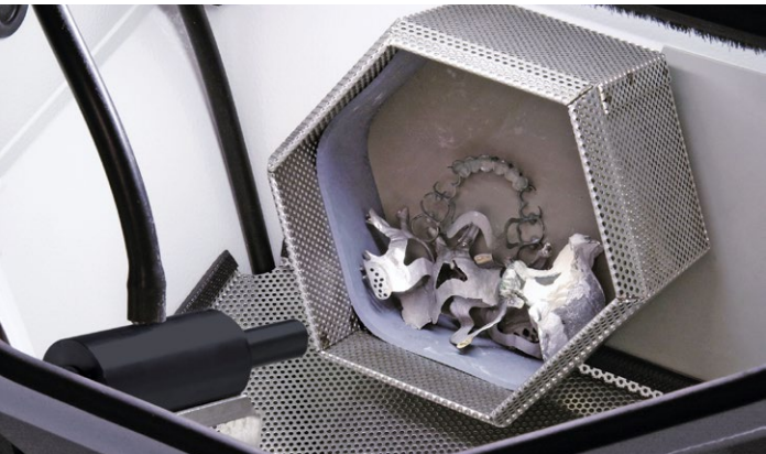
节省时间和金钱: 大型旋转钢篮允许同时为多达 7 个作业件喷砂
