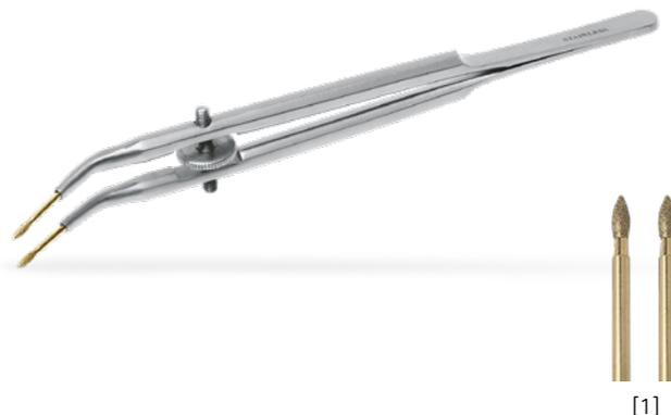
Spreizklemme zum sicheren Halt von Kronen und Brücken.
