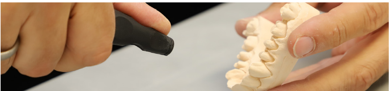
Abb. 1: Ausblasen der Werkstücke mittels Luftdruck
