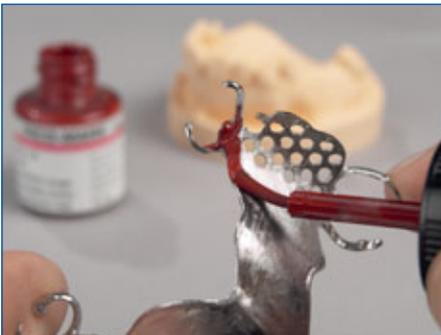
Durch die Verwendung eines Markierungslacks lassen sich die Störstellen zwischen Modellguss und Gips am besten finden.
