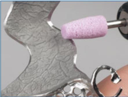
Die Abschlussränder werden auch auf der Oberseite mit dem Schleifkörper geglättet und dünn auslaufend ausgearbeitet.
