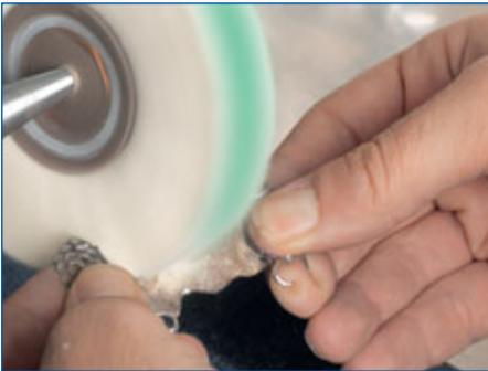
Für das Hochglanz-Finish wird der Fal-tenschwabbel aus feinem Nessel und die Hochglanzpolierpaste grün verwendet.
