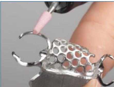
Mit einem feinen Schleifkörper werden die Klammerränder vorsichtig entgratet.
