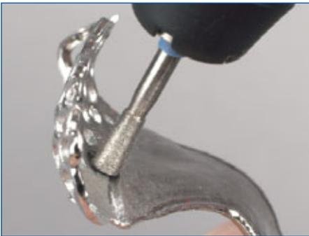
Mit einem schmalen Schleifkörper werden die basalen Abschlusslinien der Sattelbereiche scharf abgegrenzt.
