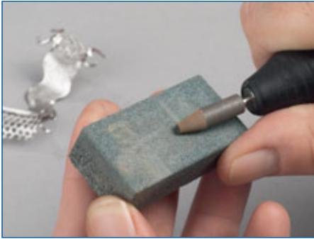
Mit einem Zurichtstein können die Polierkörper schnell in die gewünschte Form gebracht werden.
