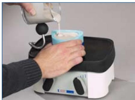
将包埋材在振荡器的辅助下缓慢倒入 硅橡胶模型。
