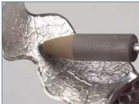
轻轻用圆胶条在点纹表面抛光.确保不要在抛光过程中破坏点纹形态。
