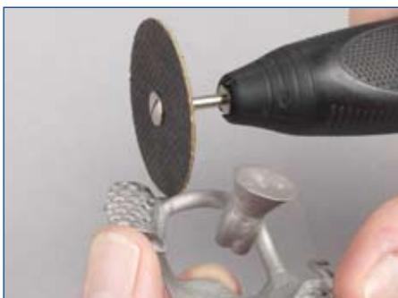
在铸道距支架 $1 \text{ mm}$ / 0.039 英寸处用玻璃纤维强化砂片切掉铸道。
