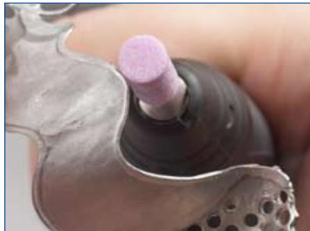
用粗砂石将横向连接体的边缘外形修整一致。
