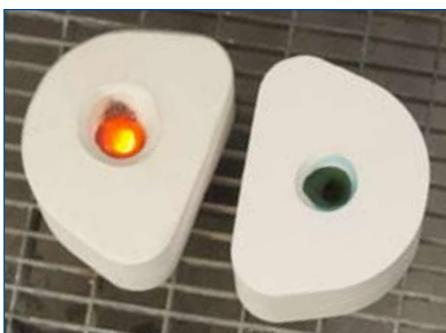
铸造后，铸件在室温内冷却。
