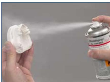
轻轻的喷上模型喷剂使模型表面光滑, 提高预成型蜡与模型的贴服度。
