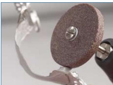
残余的铸道可以很快的用砂片去除并修整光滑。
