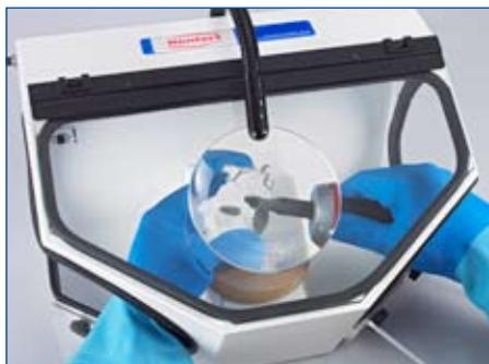
为了避免吸入有害的石英粉尘，应放在吸尘器或喷砂机内去除多余包埋材。
