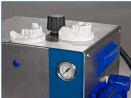
在设计之前，加热模型直到手触摸到热的程度，（例如，放在蒸汽清洗机上），以利于上蜡。
