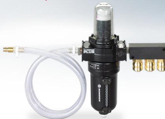
Les systèmes d'alimentation en air comprimé ne présentent plus de problèmes dus à la présence d'eau de condensation, d'huile, de résidus de couleur ou de particules de rouille provenant des compresseurs. Le filtre à air comprimé empêche la formation de grumeaux dans le jet de sable et l'obstruction des fins canaux des appareils à air comprimé par ces impuretés.
