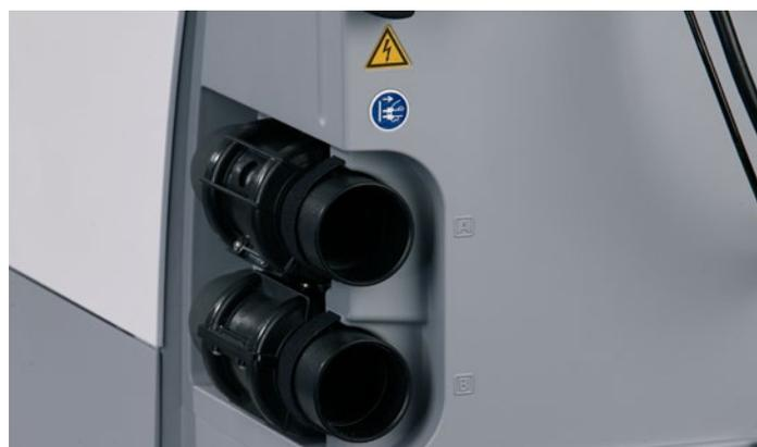
Puissance d'aspiration uniquement là où et quand il le faut grâce à la commande intelligente et indépendante des 2 vanes à manchon
