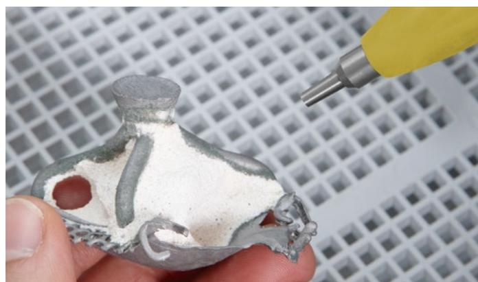
Durée de vie quatre fois plus longue par rapport aux buses classiques grâce au carbure de bore hautement résistant
