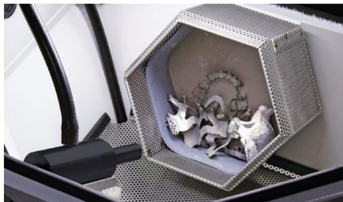
Gain de temps et d'argent : le grand panier rotatif en acier permet de sabler simultanément 7 objets
