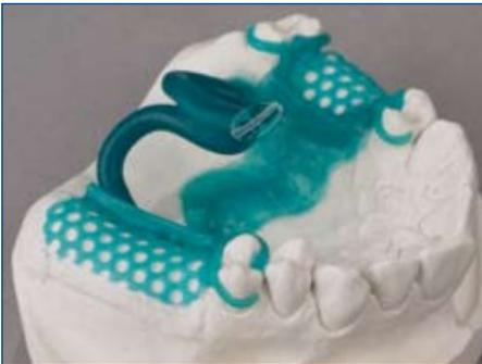
当连接铸道和铸件时，确保铸道向铸件流入途径连贯。
