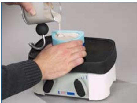
重要的是将振荡器振动调制到最适宜模式，确保在模型灌制中不会产生气泡。
