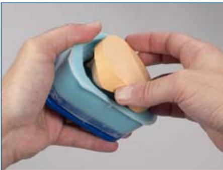
石膏模型松动后，小心的从硅橡胶模中取出。
