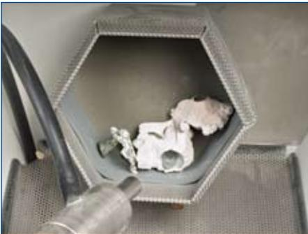
开圈后,可以用全自动的可循环的喷砂机去除金属表面包埋材以节省时间 ...
