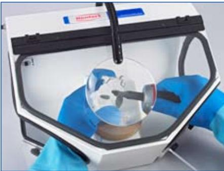
为了避免吸入有害的石英粉尘，应放在吸尘器或喷砂机内去除多余包埋材。
