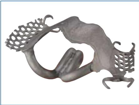
喷砂后去除支架表面包埋材和氧化物。
