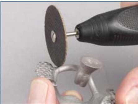
在铸道距支架1 mm/ 0.039英寸处用玻璃纤维强化砂片切掉铸道。
