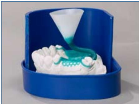
在灌制包埋材前检查预成型铸腔的高度。
