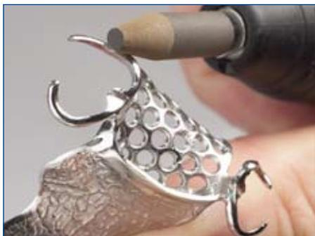
腭板的边缘终止线和非组织面的卡环表面，可以用橡胶条抛至高度光亮。
