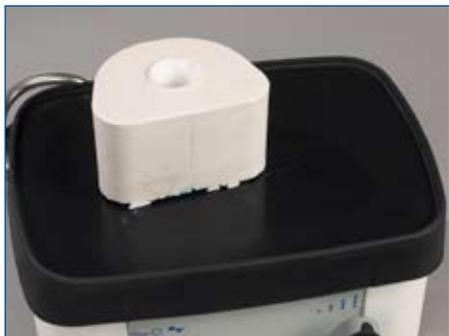
包埋材完全干燥后，拿掉型盒，底座和漏斗形预成型铸腔。
