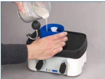
将包埋材缓慢倒入，并使用震荡器使材料充分流动。
