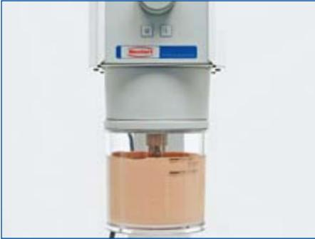
使用 IV 类石膏，通过真空搅拌机灌制工作模，以防灌制过程中产生气泡。
