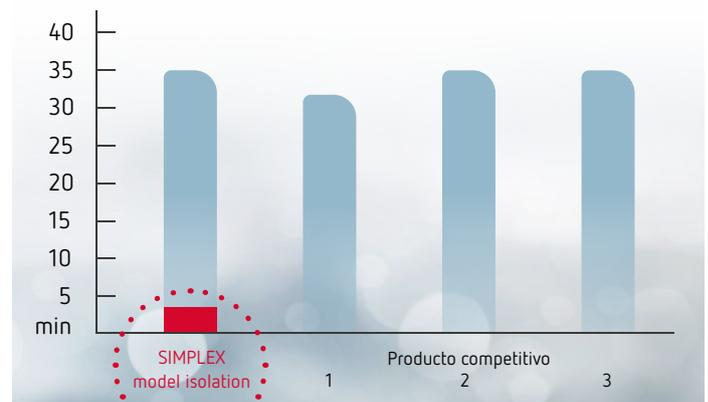
Reducción del 90 % en el tiempo de secado mediante el uso de un fotopolimerizador o una boca de aspiración
