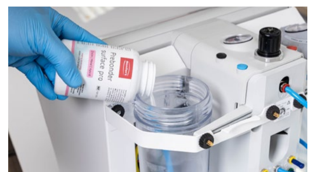
Abb. 4 Renfert bietet mit Prebonder surface pro das passende Aluminiumoxid. Dessen definierte Kornverteilung und Korngeometrie sowie Härte gewährleisten eine gleichbleibende Oberflächenstruktur ohne Materialschädigung.
