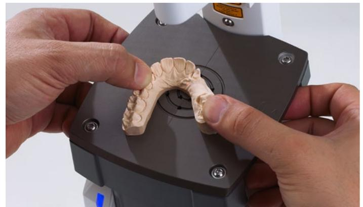
A geometria especial da broca reduz a força de perfuração em mais de 50% reduzindo o risco de ruptura das arcadas de gesso
