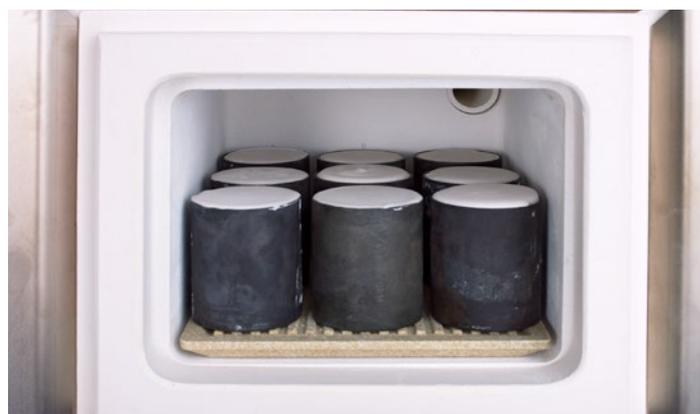
Flexibilidade: Opções de capacidade: 9 x muflas #3 ou 4 x muflas #6 ou 3 x muflas #9
