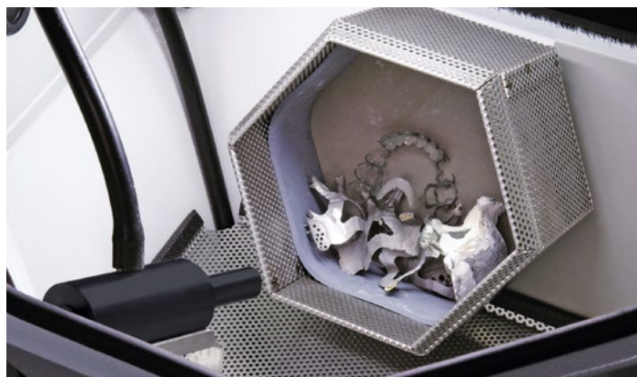
Заощаджує час та гроші: великий сталевий кошик, що обертається, дозволяє обробляти до 7 об'єктів одночасно
