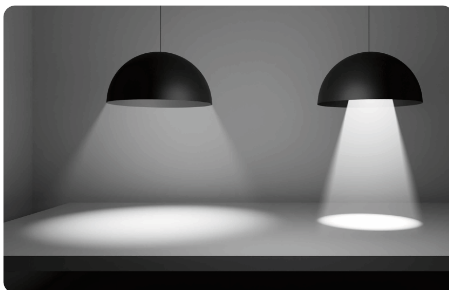
^ 03 Die Leuchten haben den gleichen Lumen-Wert, aber unterschiedliche Lichtstärken. Links: hohe Ausleuchtung, geringe Intensität; rechts: geringe Ausleuchtung, hohe Intensität.
