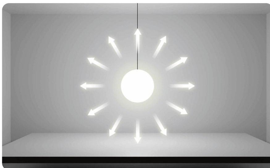
^ 02 Die Maßeinheit Lumen misst den Lichtstrom einer Lichtquelle.
