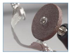
Die Gusskanalreste können mit einer Schleifscheibe sehr schnell und effektiv entfernt und geglättet werden.
