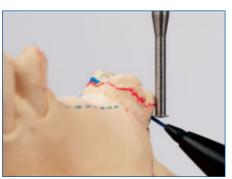
Mit dem Messteller wird die tiefste Position des Retentionsarms im Retentionsbereich festgelegt. Dabei muss der Messteller am Zahn anliegen.
