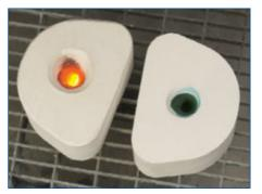
Nach dem Gießen, die Muffel auf Raumtemperatur abkühlen lassen.
