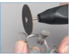
Die Gusskanäle mit einer glasfaserverstärkten Trennscheibe ca. 1 mm vom Gerüst abtrennen.
