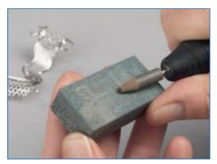
Mit einem Zurichtstein können die Polierkörper schnell in die gewünschte Form gebracht werden.
