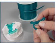
Die Form der Gusskanäle sollte einen harmonischen, winkelfreien Verlauf aufweisen und die Oberfläche des Wachses sehr alatt sein.
