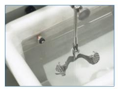
Um mögliche Schäden am Modellguss zu vermeiden sind für den Glanzprozess die Herstellerangaben genau zu befolgen, evtl. an empfindlichen Stellen (Klammerspitzen) einen Schutzlack auftragen.
