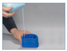
Das Dubliersilikon wird langsam, aus einer Höhe von ca. 30 cm in die Dublierküvette gefüllt.
