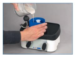
Das Einfüllen der Einbettmasse erfolgt langsam und bei einer dem Werkstoff angepassten Vibrationsstufe.
