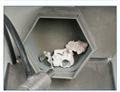
Nach dem groben Ausbetten, den Modellguss zeitsparend im vollautomatischen Umlaufstrahlgerät ...
