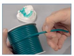
Für das Gießen werden Gusskanäle von 3,5–4 mm Durchmesser verwendet.
