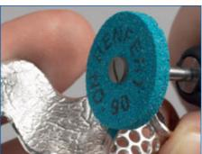
Mit dem Polierrad *Polisoft A* lassen sich die Abschlussränder der Gaumenplattenoberseite sehr gut vorpolieren.
