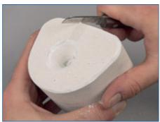
Scharfe Kanten am Gusstrichter und am Rand der Muffelaußenfläche müssen entfernt werden.
