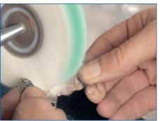
Für das Hochglanz-Finish wird der Faltenschwabbel aus feinem Nessel und die Hochglanzpolierpaste grün verwendet.
