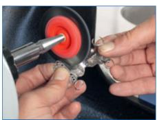
Am Poliermotor wird mit einer Spezialbürste für Modellguss und der Polierpaste Saphir der Modellguss auf Hochglanz poliert.
