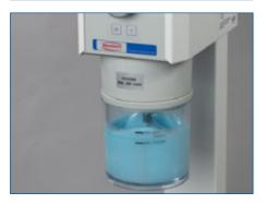
Das Dubliersilikon wird im Vakuumanmischgerät blasenfrei angerührt.
