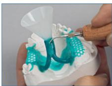
Auf die Enden der Gusskanäle wird ein konfektionierter Gusstrichter platziert und mit den Gusskanälen sauber verschwemmt.
