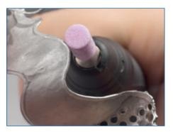
Die Abschlussränder des transversalen Verbinders werden mit einem groben Schleifkörper zu einem harmonischen Verlauf ausgearbeitet.
