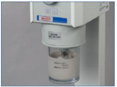
Die Modellgusseinbettmasse wird nach Herstellerangaben blasenfrei im Vakuumanmischgerät angerührt.
