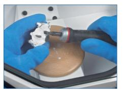
Um Spannungen im Modellguss zu vermeiden, sollte ein pneumatischer Ausbettmeißel zum groben Ausbetten verwendet werden.
