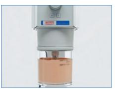
Zum Herstellen des Arbeitsmodells einen Gips der Klasse IV verwenden und in einem Vakuum-Anmischgerät blasenfrei anmischen.
