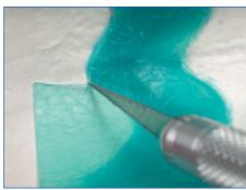
Die genarbte Gusswachsplatte wird genau der Randbegrenzung folgend abgeschnitten. Die Transparenz des Gusswachses erleichtert das richtige Zuschneiden.
