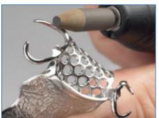
Um die Polierwirkung zu erhöhen, werden die Abschlussränder der Gaumenbasis und die Klammeraußenflächen mit der Gummipolierwalze nachbearbeitet.
