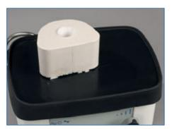
Nach dem vollständigen Aushärten der Einbettmasse werden Manschette, Sockel und Gusstrichter entfernt.
