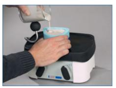
Die Einbettmasse wird langsam mithilfe eines Rüttlers in die Dublierform eingefüllt.
