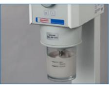
Die Einbettmasse nach Herstellerangaben unter Vakuum blasenfrei anrühren.
