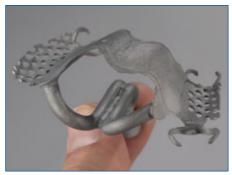
Nach dem Abstrahlen muss der Modellguss frei von Einbettmasse und Oxid sein.
